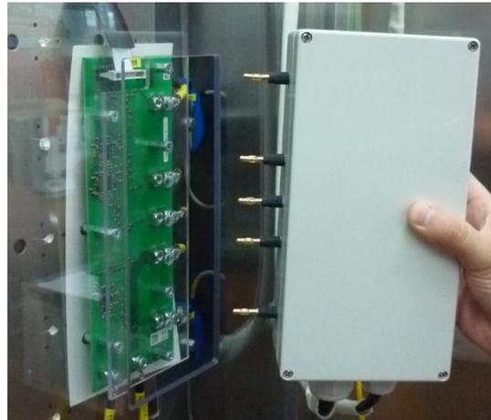
Bild 13: Entladevorrichtung anbringen
