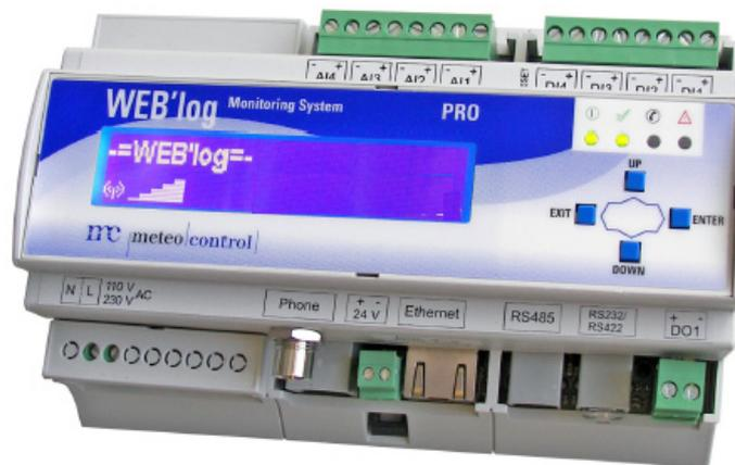
Der WEB'log muss mit den Signalleitungen der Wetterstation, mit dem 230/(220)-Volt-AC-Netzanschluss, mit dem RS485-Bus zu S7 und i'checker) und dem Ethernet-Bus verbunden werden.
